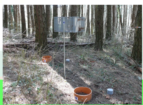
CESTINI PER LA RACCOLTA DELLA LETTIERA CAMERE PER LA MISURA DELLE EMISSIONI SERRA
